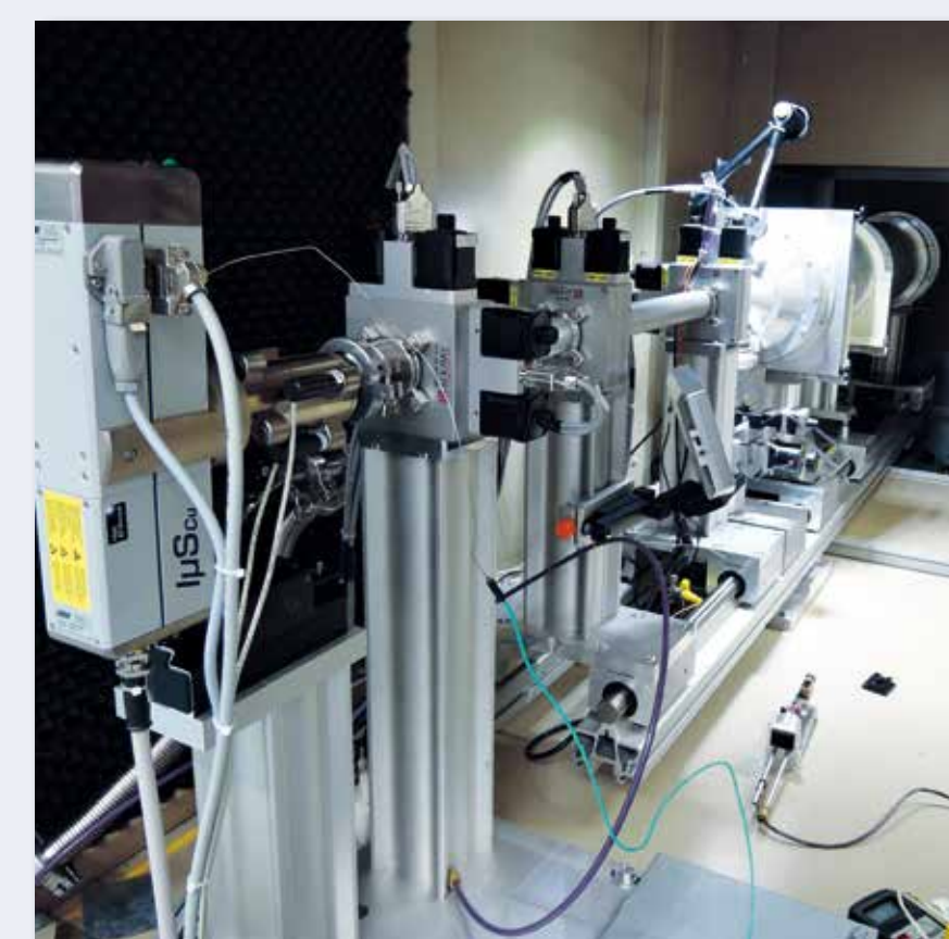
用微焦源和无散射针孔升级SAXS系统 —汉堡, 德国
